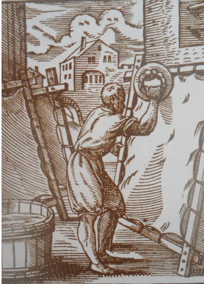
Fotoęraf 13 Parřmen yapımında kullanılan; koyun, kei, ceylan, antilop gibi hayvanların derisinden uzun ve zahmetli bir srete inceltilip yzeyi przlerden arındırılması rneęi
