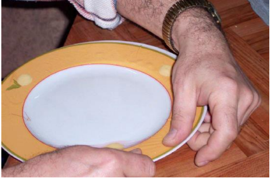
Şekil 7.3 Porselen üzerine dekal (Sulu çıkartma) uygulaması.
