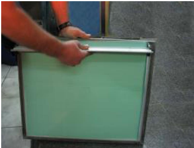
Şekil 6.4 Emülsiyonun Kalıba Uygulanışı.
